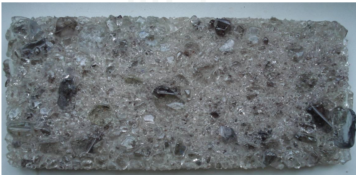
Vzorek vyrobený z demontovaných obrazovek (kónusová část – frakce o až 16 mm) vyrobený při maximální teplotě 700 °C
