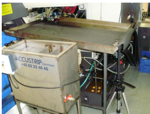
Instalace separátoru na stroji
