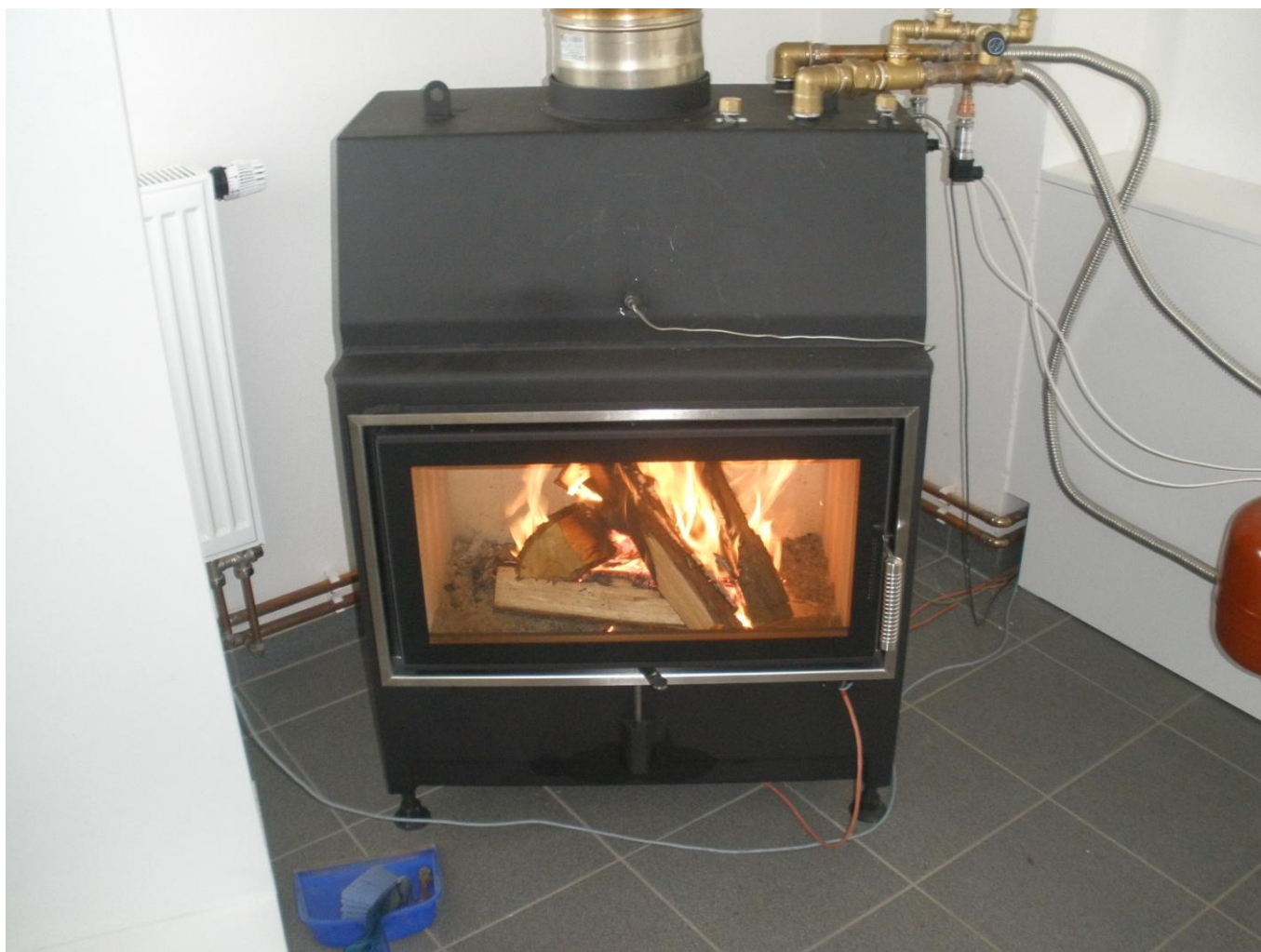
Krbová vložka Hoxter 67/38W napojená na zkušební okruh
